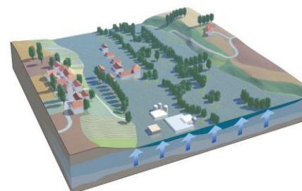
inondation de nappe
